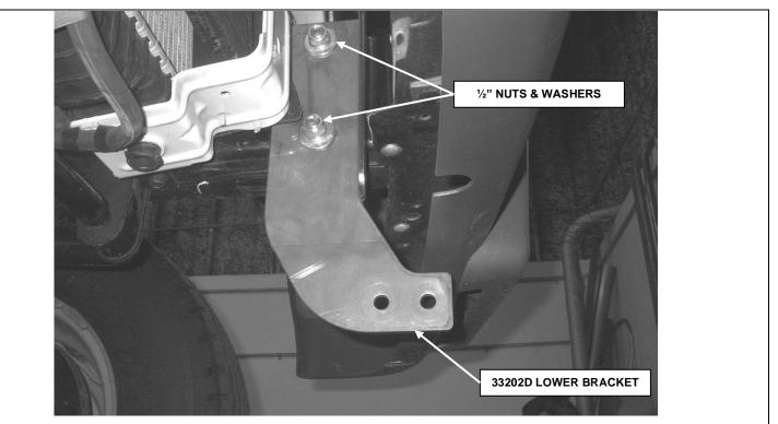
**STEP 5.** POSITION 33202D LOWER BRACKET OVER THE ½" BOLTS, AND LOOSELY ATTACH THE BRACKET TO THE SIDE OF THE FRAME USING THE ½" NUTS AND WASHERS. REPEAT THE ABOVE STEPS FOR THE PASSENGER SIDE BRACKET.
