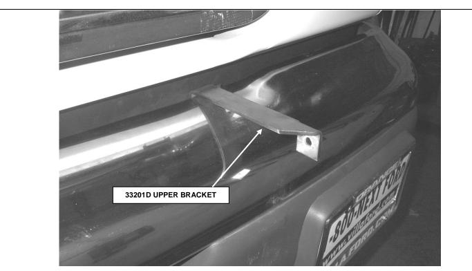
**STEP 3.** POSITION 33201D UPPER BRACKET BETWEEN THE GRILLE LOWER PANEL AND BUMPER. LOOSELY ATTACH THE BRACKET TO THE BUMPER USING THE FACTORY BUMPER BOLT. REPEAT THE ABOVE STEPS FOR THE PASSENGER SIDE BRACKET.
