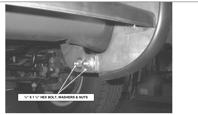
**STEP 6.** ATTACH THE GRILLE GUARD ASSEMBLY TO THE LOWER BRACKETS, USING THE ½" x 1 ½" HEX BOLTS, WASHERS AND HEX NUTS.
