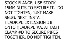
**INSTALL HEADPIPE #A ONTO**
