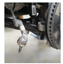
Fig. 2: Tie rod end link.
