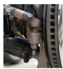
Fig. 16: Tie rod end link.
